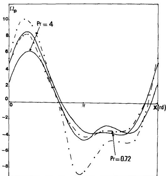
FIG. 2. Distribution angulaire du frottement partiel. — Mod le de Boussinesq. - - - Propri t s physiques variables.
